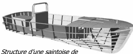
Structure d'une saintoise de 9m en aluminium
