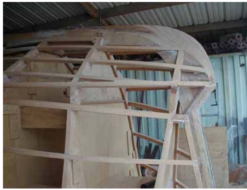
Le bulbe du P214 en construction.
